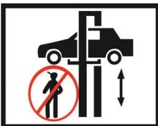
Halten Sie beim Anheben oder Absenken des Fahrzeugs Abstand zur Hebebühne.
