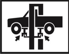
Verwenden Sie bei Bedarf Höhenverlängerer, um einen guten Kontakt sicherzustellen.
