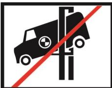
Positionieren Sie das Fahrzeug mit dem Schwerpunkt in der Mitte zwischen den Adaptern.
