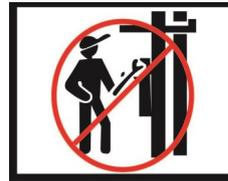
Übersteuern Sie nicht die selbstschließenden Aufzugssteuerungen.
